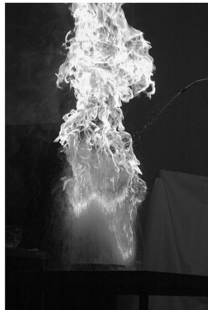
Naturwissenschaft wird greifbar am Beispiel eines Löschversuches: Was passiert, wenn Wasser auf einen Fettbrand trifft?
