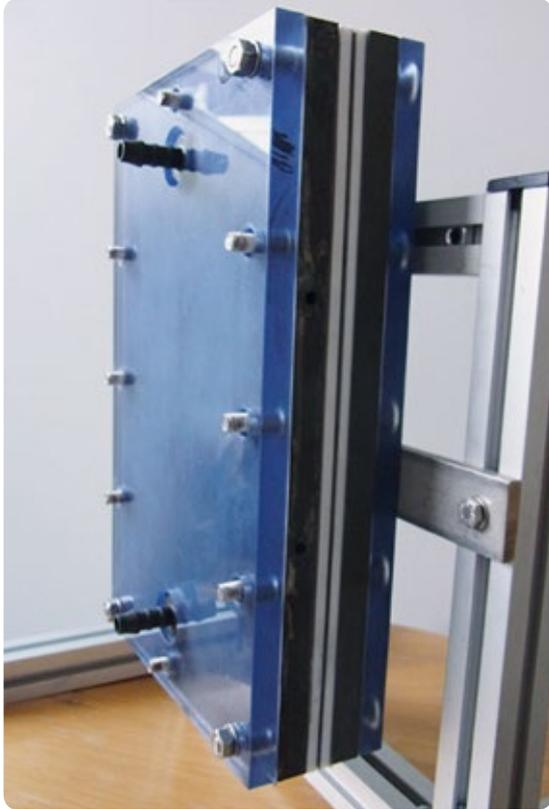
*Reaktor zur potenzialgesteuerten Adsorption und Desorption*
